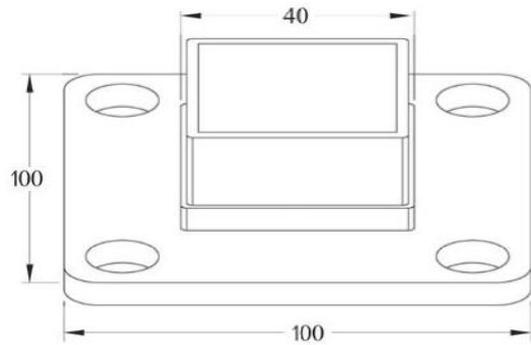
**Supporto INOX a pavimento per tubo 40 x 40 x 2 mm**
