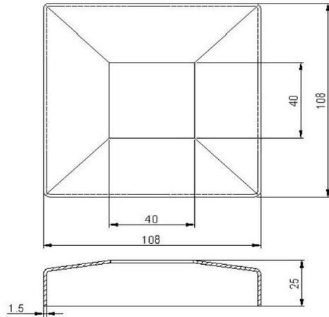
**Calotta INOX 108 x 108 mm per tubo 40 x 40 mm**
