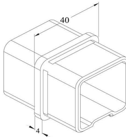
**Giunzione INOX fissa per tubo 40 x 40 x 2 mm**
