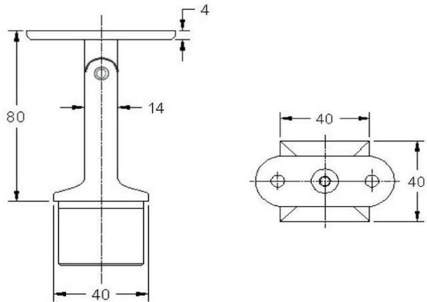
**Sostegno INOX regolabile per tubo 40 x 40 x 2 mm**
